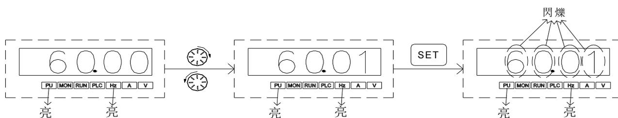
注：1. 當變頻器在運轉狀態下操作鍵盤旋鈕修改頻率。
