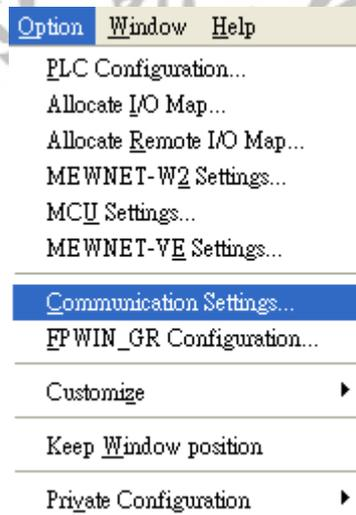
3. 下圖為電腦與 PLC 之通訊的設定畫面。其中【Network type】可選擇 C-NET(RS232C)、Ethernet 與 USB 等三種。
