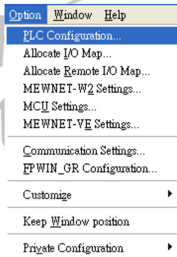
5. 下圖為 PLC Configuration 之設定畫面。可依需要設定 Tool Port 與 COM PORT 之通訊格式，設定完成按下【OK】。
